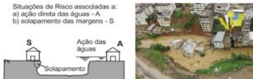
FIGURA 14. A) SITUAÇÕES DE RISCO ASSOCIADAS ÀS MARGENS DE CÔRREGOS, EM RAZÃO DA POSSIBILIDADE DE OCORRÊNCIA DE SOLAPAMENTOS E/OU DA PRÓPRIA AÇÃO DIRETA DAS ÁGUAS, QUANDO DO REGISTRO DE CHUVAS INTENSAS. B) SITUAÇÃO EM QUE HOUE DANOS ÀS MORADIAS EM RAZÃO DE SOLAPAMENTOS E AÇÃO DIRETA DAS ÁGUAS.
