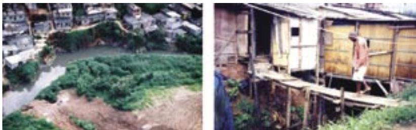
FIGURA 13. A) VISTA AÉREA DE LOCAL NO QUAL AS MORADIAS FORAM INSTALADAS PRÓXIMAS À MARGEM DE CÔRREGO, CARACTERIZANDO ÁREA DE RISCO ASSOCIADA A SOLAPAMENTOS. B) VISTA DE LOCAL NO QUAL AS MORADIAS FORAM CONSTRUÍDAS SOBRE O PRÓPRIO LEITO DA DRENAGEM, CARACTERIZANDO ÁREA DE RISCO ASSOCIADA A AÇÃO DIRETA DAS ÁGUAS.
